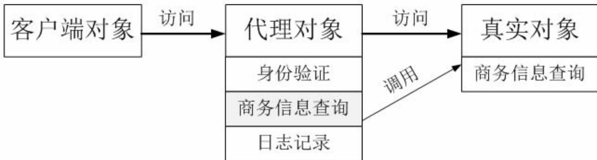
图15-3 商务信息查询系统设计方案示意图
