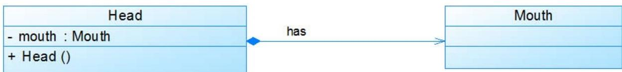
在代码实现组合关系时，通常在整体类的构造方法中直接实例化成员类，图7对应的Java代码片段如下：
